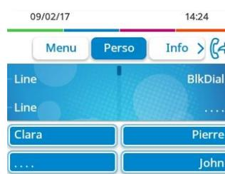
Interface utilisateur avec module d'extension virtuel. 4 touches programmables sont affichées et peuvent être utilisées comme module d'extension intelligent.
