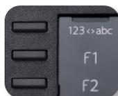
Le poste 8018 DeskPhone utilise 3 touches pré-programmées pour accéder à certaines fonctions. Dans ce cas, la description de la fonction (icône) est imprimée sur l'étiquette. Utiliser la fonction en appuyant sur la touche correspondante. La LED de la touche reste allumée lorsque que la fonction associée à cette touche est activée. Appuyer à nouveau sur la touche pour la désactiver.
