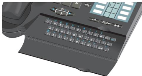
Ce clavier est utilisé pour la fonction d'appel par nom.
