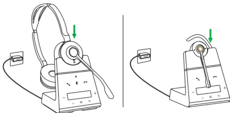
Le micro-casque se charge lorsqu'il est placé sur un socle qui est branché à une alimentation électrique. La LED d'état du micro-casque et l'icône de batterie du socle clignoteront pour indiquer que le micro-casque est en charge.
