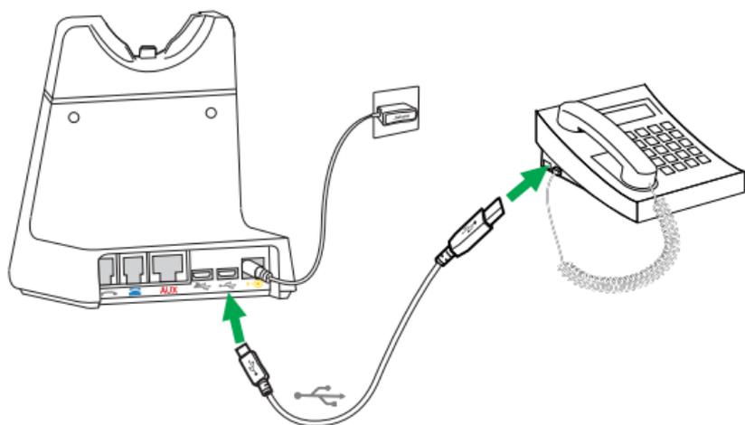
1. Branchez un câble micro-USB sur le port marqué
