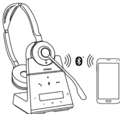
1. Branchez le socle à une alimentation électrique à l'aide du câble électrique fourni.
