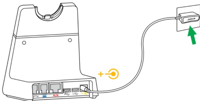
Branchez le socle à une alimentation électrique à l'aide du câble électrique fourni.
