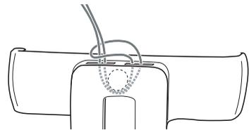
**Aastra 630:** Un système d'attache pour tour de cou est disponible en tant qu'accessoire. Pour fixer le support, il convient de remplacer le clip de ceinture vissé sur le combiné par le système d'attache pour tour de cou.
